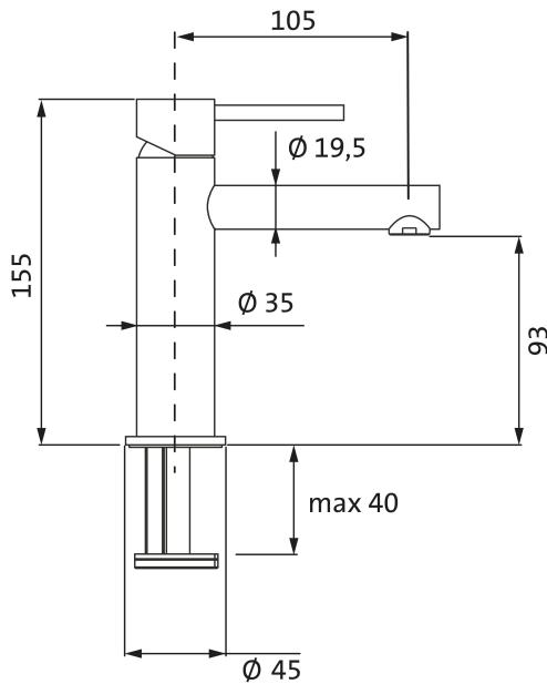
Lochbohrung Ø 35 mm
