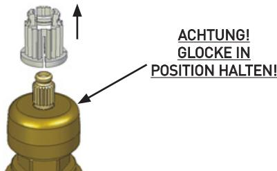
2. Zur Fixierung der Glocke die Klammer aus dem Beipack 10867 in die Führung oberhalb der Glocke schieben.
