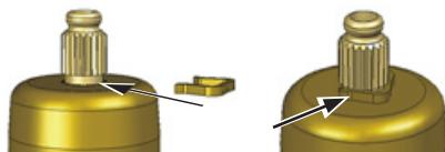
4. **NACH DEM EINPUTZEN** der Traverse die Langspindel auf die Sternaufnahme des Keramikscheibenabsperrventils aufstecken.
