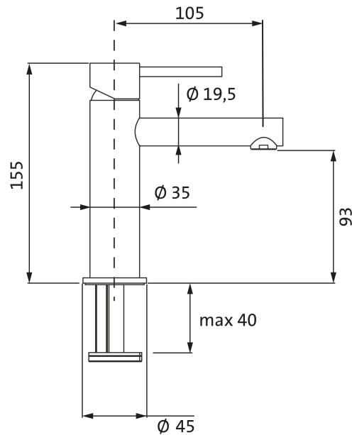
Lochbohrung  $\varnothing$  35 mm
