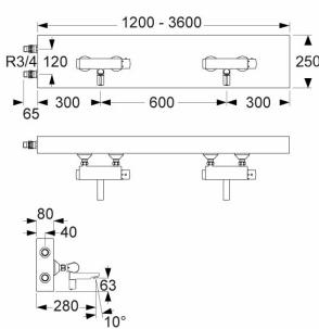
Vorgefertigte Armatureneinheit mit berührungslosen Wandarmaturen Aufputz lino W35, verchromt, und kompletter Verteilerleitung in einem Aufputz-Verteiler aus nichtrostendem Stahl, für Wandaufbau.
