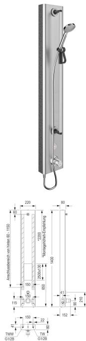
Elektronische Duscheinrichtung für elektronisch gesteuerte bezahlte Wasserabgabe. Ausgeführt als Duschelement in Nennweite DN15. Mit thermostatischer Mischeinrichtung zum Anschluss an Kalt- und Warmwasser. Einsatzbereich im Neubau und Sanierung in öffentlichen, halböffentlichen und gewerblichen Sanitärräumen.
