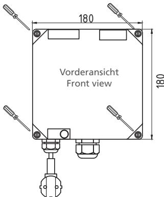
Gehäuse mit Schlitzschraubendreher öffnen.
