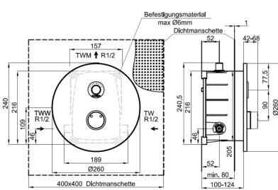
Fertigmontageset für elektronische Duscheinrichtung, ausgeführt als Unterputz-Dusche in Nennweite DN15. Mit thermostatischer Mischeinrichtung zum Anschluss an Kalt- und Warmwasser. Einsatzbereich im Neubau und Sanierung in öffentlichen, halböffentlichen und gewerblichen Sanitärräumen.
