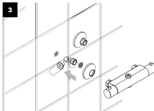
Zum Schutz der Armatur vor Leitungseinspülungen beiliegende Siebdichtungen einsetzen.
