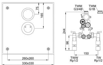
Mechanische Duschumrüstung mit thermostatischer Mischeinrichtung inklusive Verbrühungsschutz:
