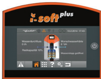
Touch-Display i-soft plus Ansicht Betriebsstatus
