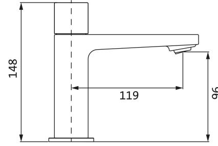
Lochbohrung Ø 35 mm
