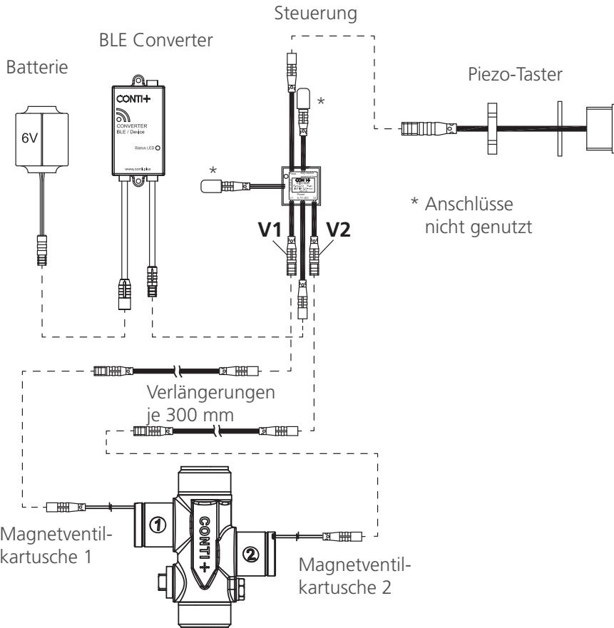
! Um Batteriekapazität zu sparen, wechselt der BLE Converter bei Nicht-Benutzung automatisch in den Ruhemodus. Im Ruhemodus sind Einstellungen über die ServiceAPP nicht möglich. Zum Beenden des Ruhemodus muss der Piezo-Taster 8x gedrückt werden (4x Wasserfluss). Nach 2 Minuten Innaktivität wechselt der BLE Converter wieder in den Ruhemodus.
