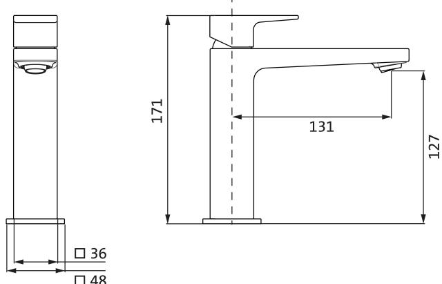
Lochbohrung Ø 35 mm
