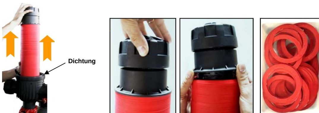
Abb. 12: Kunststoffdiscs reinigen und Dichtung kontrollieren
