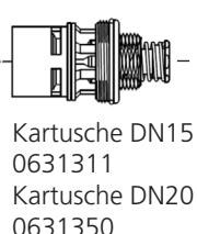
Nach dem Spülen der Rohrleitung, Blindstopfen aus dem Gehäuse schrauben, Kartusche (DN15 / DN20) einsetzen und mit beiliegendem Steckschlüssel (SW24) festziehen.
