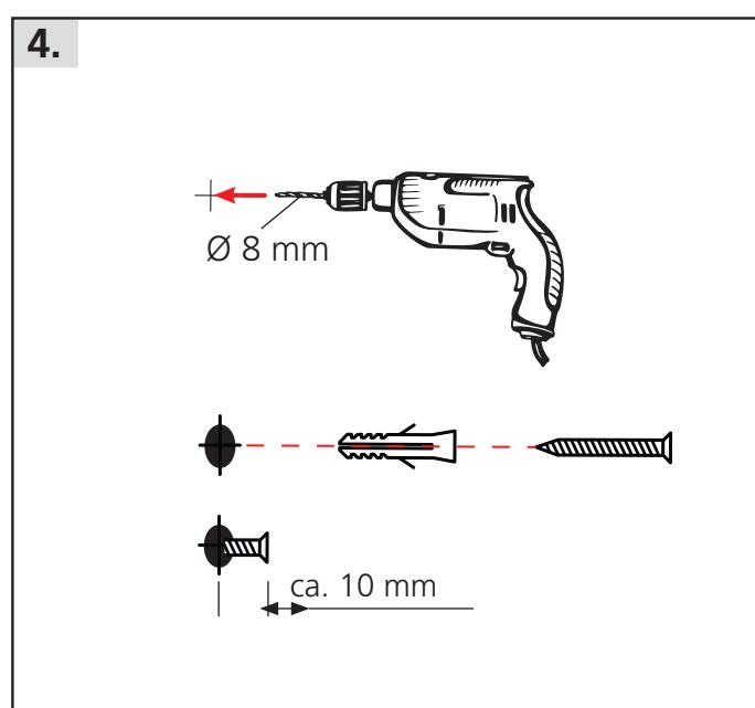
Bohrung erstellen, Dübel einstecken und Schraube einschrauben (TORX SW25). Schraubenkopf etwa 10 mm vorstehen lassen.
