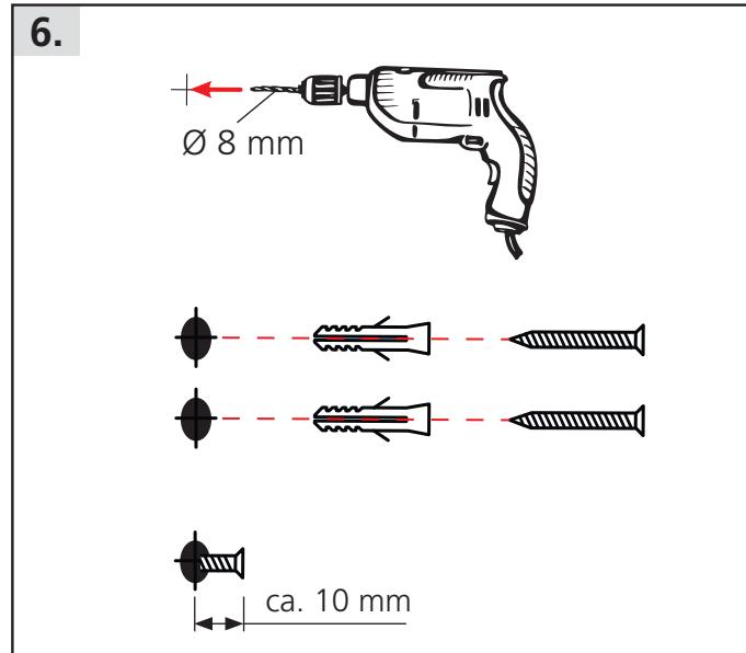
Bohrungen erstellen, Dübel einstecken und Schrauben einschrauben (TORX SW25). Schraubenköpfe etwa 10 mm vorstehen lassen.
