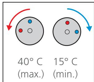
Um die Temperatur der Wasserabgabe zu regeln, den Temperaturgriff wie abgebildet nach links bzw. rechts drehen.
