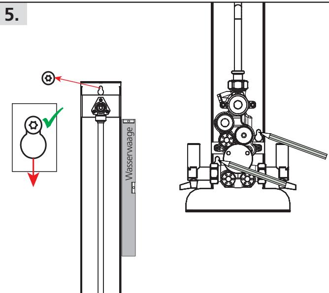
Rückwand oben einhängen, mit Wasserwaage ausrichten und untere Bohrungen anzeichnen.
