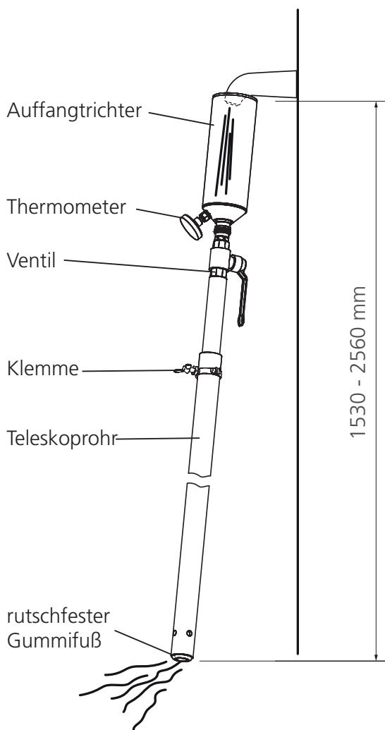
Das Service-Rohr zwischen Brausekopf und Boden mittels verstellbarer Länge des Rohres einklemmen.
