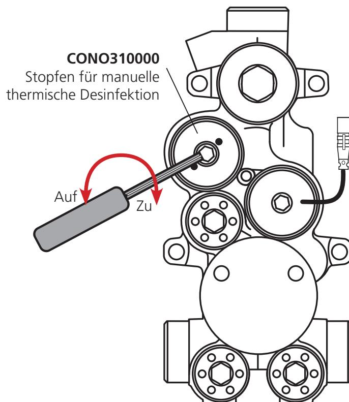
Zum Ausführen einer manuellen, thermischen Spülung, einen Sechskant-Schlüssel (SW3) in den Bypass-Stopfen einführen und das Ventil öffnen
