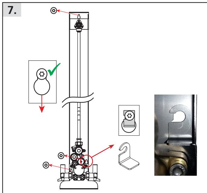
Rückwand einhängen und den Sicherungswinkel an unterer, rechter Befestigung wie abgebildet anbringen.
