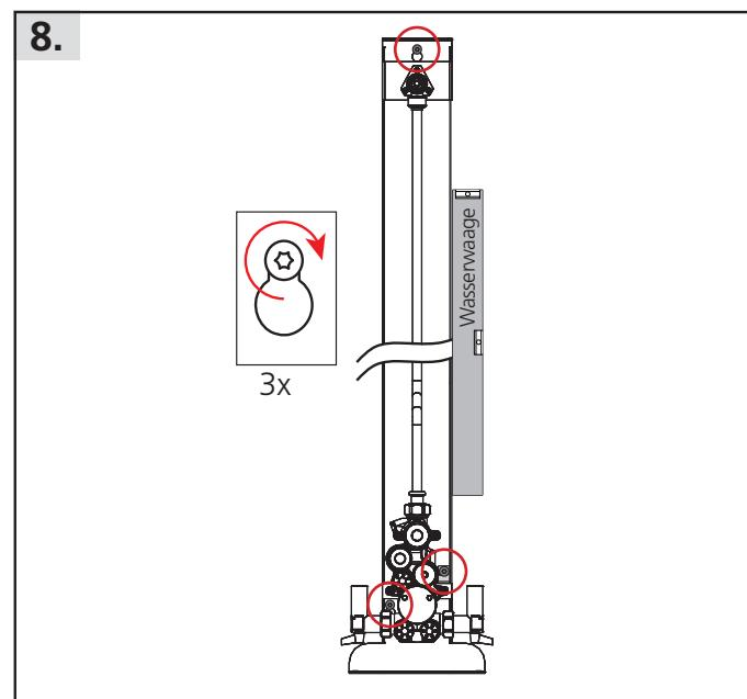
Rückwand unter Beachtung der lotrechten Ausrichtung festschrauben.
