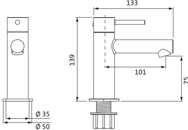
Lochbohrung  $\varnothing$  35 mm
