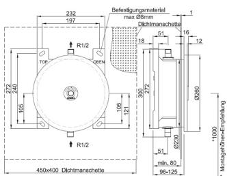
Fertigmontageset für elektronische Duscheinrichtung, ausgeführt als Unterputz-Dusche in DN15. Ohne Mischeinrichtung zum Anschluss an Kalt oder vorgemischtem Wasser. Einsatzbereich im Neubau und Sanierung in öffentlichen, halböffentlichen und gewerblichen Sanitärräumen.
