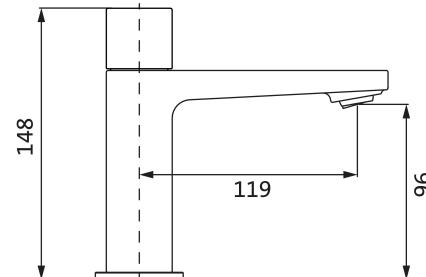
Lochbohrung Ø 35 mm
