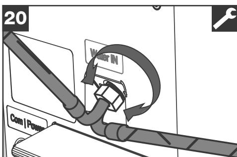
Sollte es aufgrund der Einbausituation vorteilhaft sein, den Schlauchanschluss zu drehen, so können sie die Mutter an der Kühleinheit leicht lösen, den Anschluss auf die gewünschte Ausrichtung drehen und anschließend die Mutter wieder vorsichtig und dicht anziehen.
