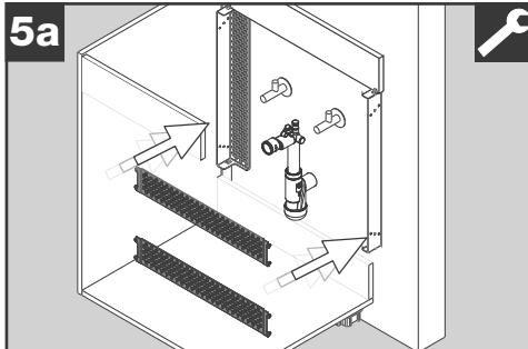
Die beiden Quertraversen in der passenden Höhe in die Langlöcher der Seitenteile einhängen. Dabei Kollisionen mit den Eckventilen und dem Siphon vermeiden.
