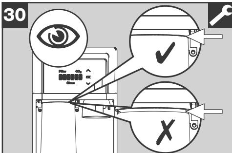
Kontrollieren, ob die Filterkartusche komplett eingedreht ist. An der Aufnahme darf kein Spalt vorhanden sein!
