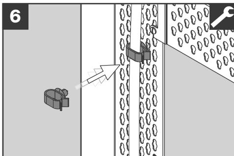
Mit den beiliegenden Clips können im weiteren Montageprozess Kabel und Leitungen an den Rahmenteilen fixiert werden.
