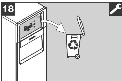
Schutzfolie vorsichtig und langsam vom Display entfernen und recyceln. Durch statische Aufladung können auf dem Display Anzeigefehler auftreten. Diese verschwinden nach einiger Zeit wieder von selbst.
