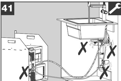
Überprüfen Sie nochmals die Dichtigkeit aller wasser- und abwasserführenden Verbindungen.
