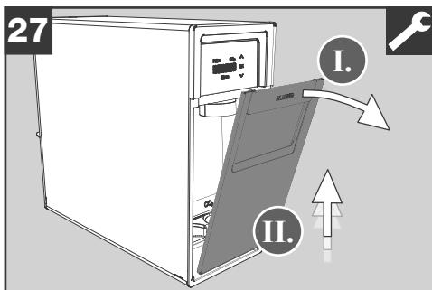
Klappe an der Kühleinheit vorne abnehmen.
