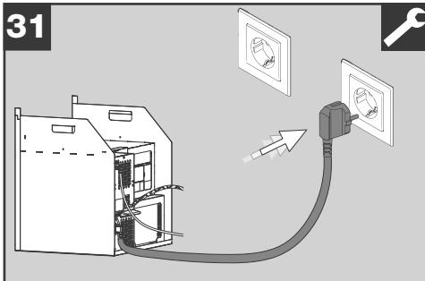
Stromkabel der Kühleinheit an einer Steckdose mit Schutzkontakt anschließen.
