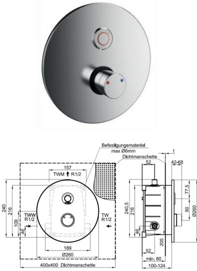
Fertigmontageset für elektronische Duscheinrichtung, ausgeführt als Unterputz-Dusche in Nennweite DN15. Mit thermostatischer Mischeinrichtung zum Anschluss an Kalt- und Warmwasser. Einsatzbereich im Neubau und Sanierung in öffentlichen, halböffentlichen und gewerblichen Sanitärräumen.
