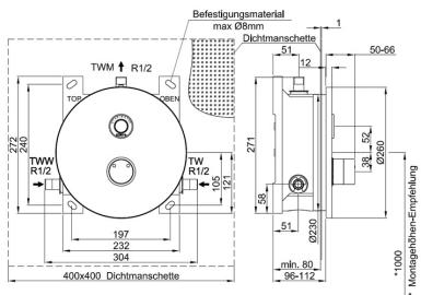
Fertigmontageset für elektronische Duscheinrichtung, ausgeführt als Unterputz-Dusche in Nennweite DN15. Mit thermostatischer Mischeinrichtung zum Anschluss an Kalt- und Warmwasser. Einsatzbereich im Neubau und Sanierung in öffentlichen, halböffentlichen und gewerblichen Sanitärräumen.
